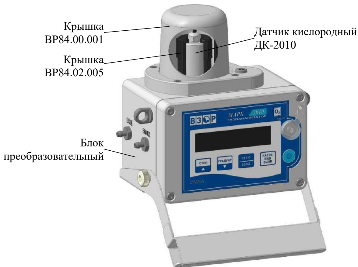
Рисунок 1.1 – Газоанализатор МАРК-2010 (вид с местным разрезом)
